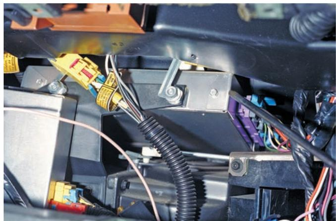
**Figure 2-55** Les câblages de systèmes de coussins gonflables sont reliés par des connecteurs jaunes. Respectez toujours les règles de sécurité qui s'imposent et référez-vous aux procédures du fabricant avant de travailler sur ces systèmes.
