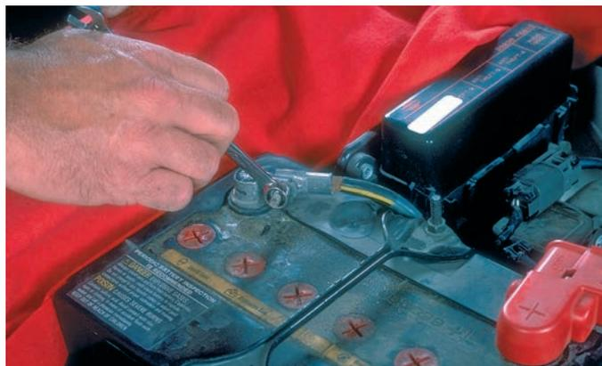
**P2-2** Retirez le fusible du circuit à réparer. Si le circuit n'est pas protégé par un fusible, débranchez la borne négative de la batterie d'accumulateurs.
