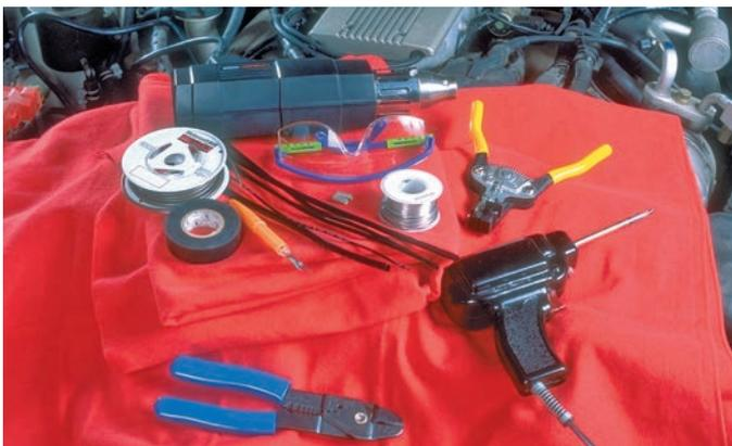
**P2-1** Outils requis pour souder deux fils de cuivre : fer à souder de 1000 W, soudure à résine 60/40, outil de sertissage, collier de jonction, isolant thermorétractable, pistolet à air chaud électrique et lunettes de protection.
