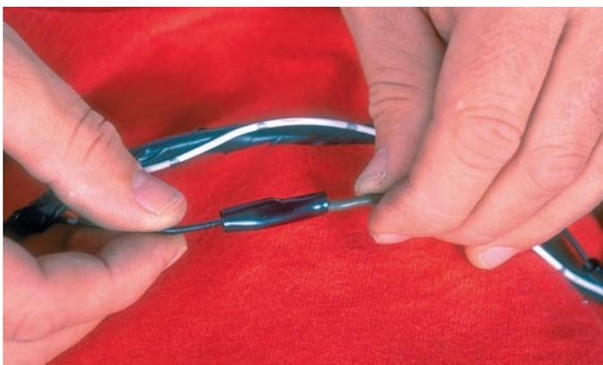
**P2-11** Déposez le fer à souder dans son support. Une fois la soudure refroidie, glissez la pièce d'isolant thermorétractable sur l'ensemble de la jonction.
