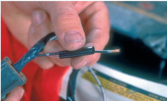
**P2-7** Coupez deux longueurs suffisantes d'isolant thermorétractable de calibre approprié et placez-en une autour de chaque extrémité du fil existant.
