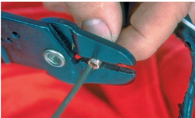
**P2-9** Pressez fermement sur le collier de jonction avec l'outil de sertissage.
