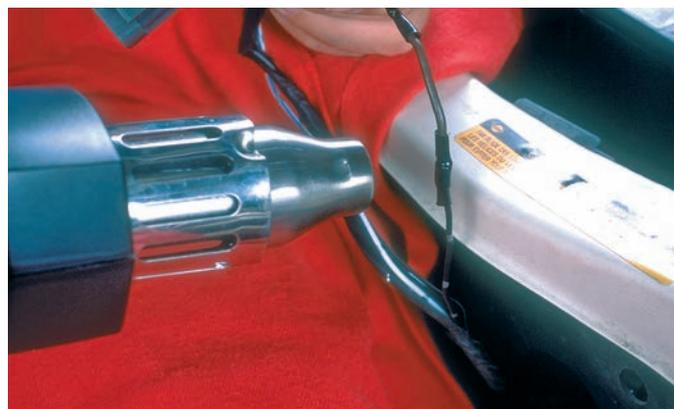
**P2-12** Chauffez l'isolant avec le pistolet à air chaud pour qu'il se rétracte autour de la jonction, sans le surchauffer.
