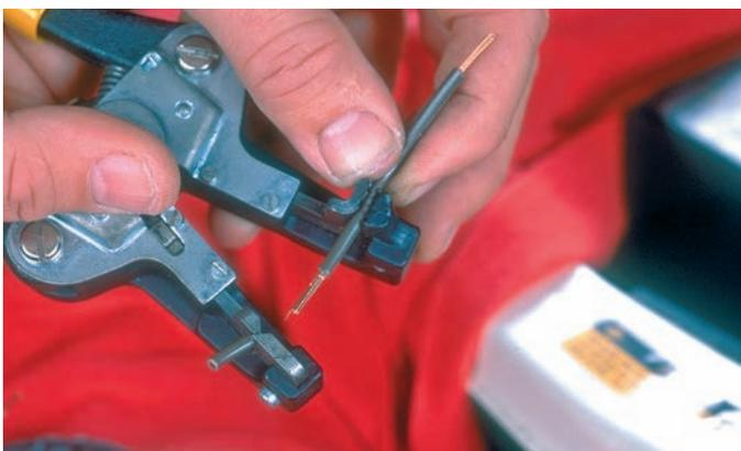
**P2-5** Coupez un fil de remplacement environ 2 cm plus long que la portion endommagée enlevée. Retirez ensuite l'isolant sur les extrémités du fil de remplacement sur environ 1 cm.
