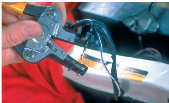
**P2-4** Retirez l'isolant sur les extrémités du fil existant sur environ 1 cm en utilisant un dénude-fil de taille appropriée.
