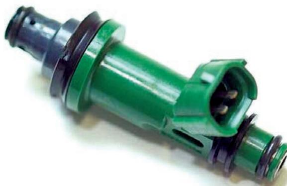
**Figure 3-24** Injecteur de système d'injection directe.
